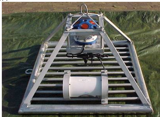
Figuur 3 ADCP geplaatst in meetframe
